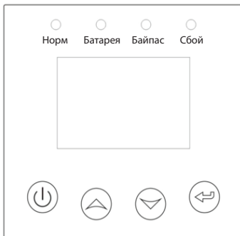
Рис. 5-1: Изображение контрольной панели ИБП
