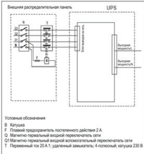
Рис. 6-5 Модель 10 кВА Компакт и внешнее изолирующее устройство
