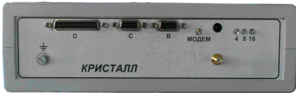
Рис. 2. Расположение разъемов на блоках СДК- 31.x15
